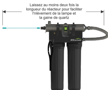
Figure 3. Espacement requis pour enlèvement de la lampe
